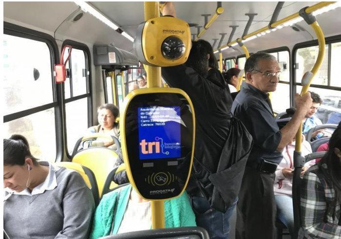
Imagem I: Validadores de passagem, com identificador facial e GPS integrados (Fonte: Jornal do Comércio, 2018)
