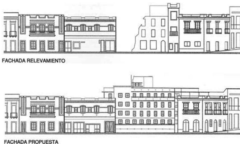
Figura 1- Comparação da preexistência e o projeto da COVICIVI, hoje construído. Fonte: https://produccionsocialhabitat.wordpress.com/galeria-de-casos/fucvam/
