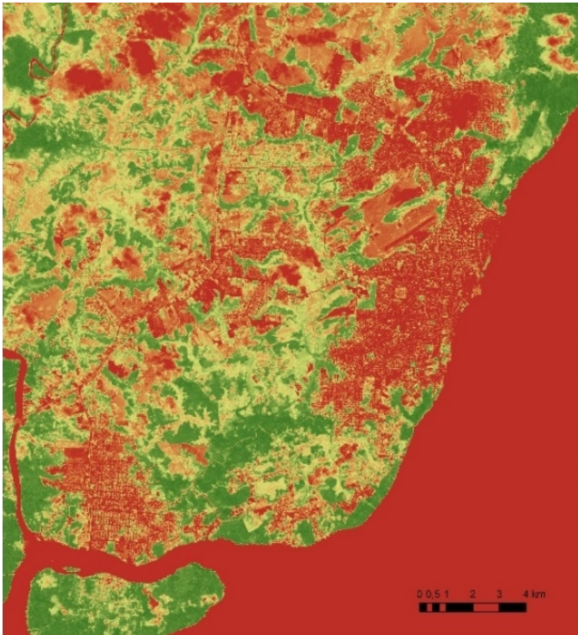
Figura 5. Imagem Sentinel da área urbana de Macapá tratada com algoritmo NDVI (fonte: elaborada pelos autores, 2020)
