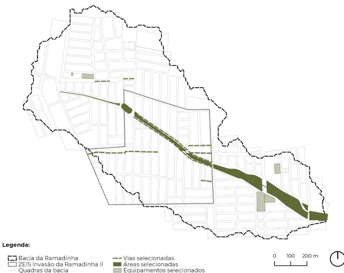
**Figura 4.** Cartograma de áreas, vias e equipamentos selecionados para aplicação dos SUDS (fonte: elaborada pelos autores, 2022).
